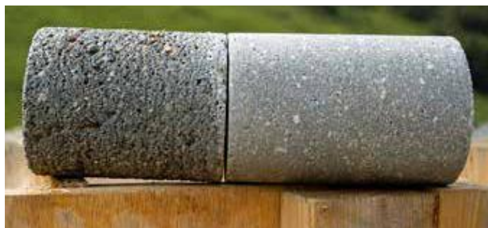
Fig. 1: Dos núcleos (realizados por dos lanzadores diferentes con la misma mezcla de concreto) producen resultados muy distintos.
