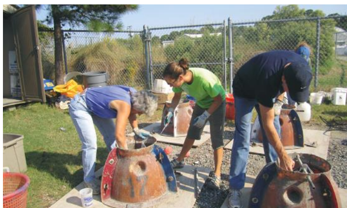
Fig. 7: La Reef Ball Foundation ha desarrollado un diseño de mezcla estándar adecuado para fabricar módulos de arrecife artificial en moldes complejos, con un pH mínimo, y para favorecer el asentamiento y crecimiento de especies marinas típicas, como los corales duros (fotografía cortesía de la Chesapeake Bay Foundation)
