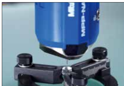
Medición con MPP-NANO de una forma esférica
