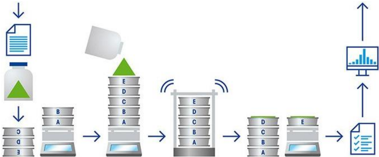
Abbildung 3: typischer Arbeitsablauf einer trockenen Siebanalyse (Quelle: METTLER TOLEDO)
