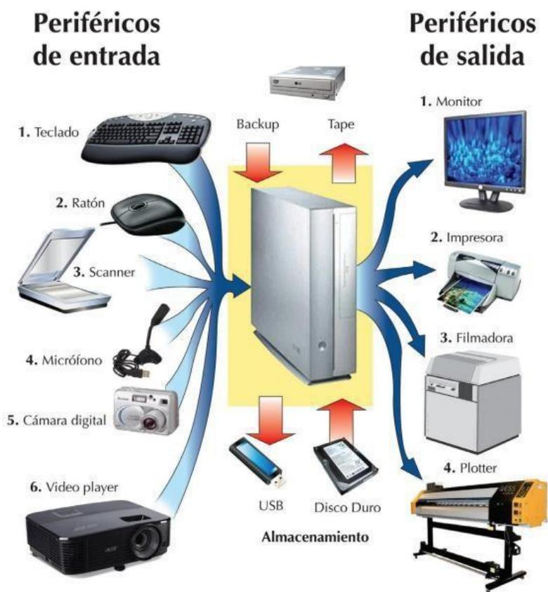
Figura 1.3. Componentes básicos de una computadora personal.
