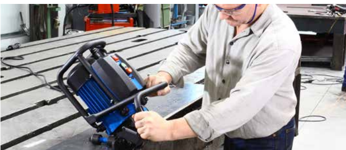
Mit ergonomischer Griffanordnung. Leicht zu führende Rollenführung.
