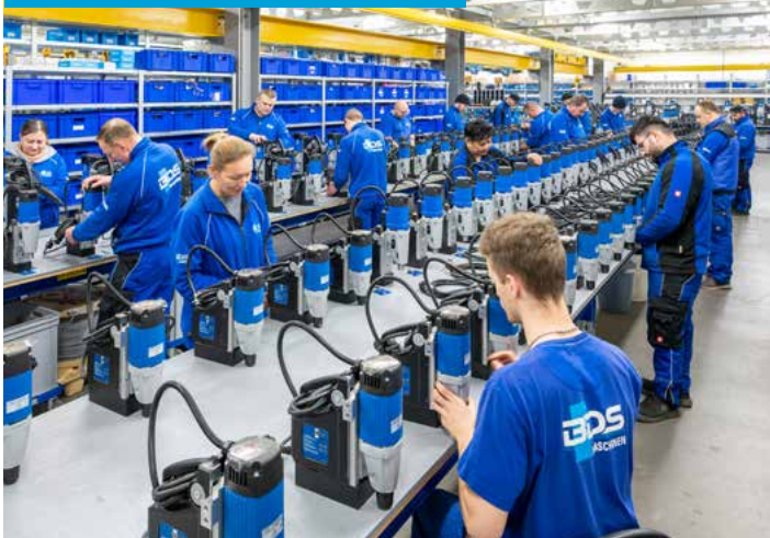
Montagelinie für Magnetbohrmaschinen
