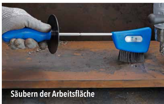
Entfernen der scharfkantigen Bohrspäne
