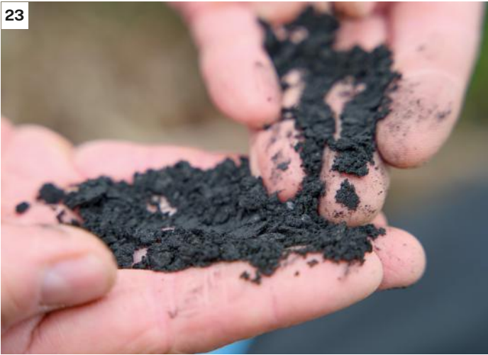
23 Voorbij Prefab maakt sinds kort Impakt Beton op basis van organisch restmateriaal: biochar. Biobeton zit in CO 2 -reductie nu al op het niveau van Parijs 2050. Yes! Winnaar van de TBI Innovatieprijs 2025. 24 Levend Leslokaal op de bouwplaats in Gouda: hier ontdekken leerlingen van basisscholen, middelbare scholen en mbo-bouwopleidingen hoe leuk restaureren en bouwen kan zijn. Praktijk, plezier en vakmanschap komen samen, leren doe je hier gewoon tussen de steigers!
