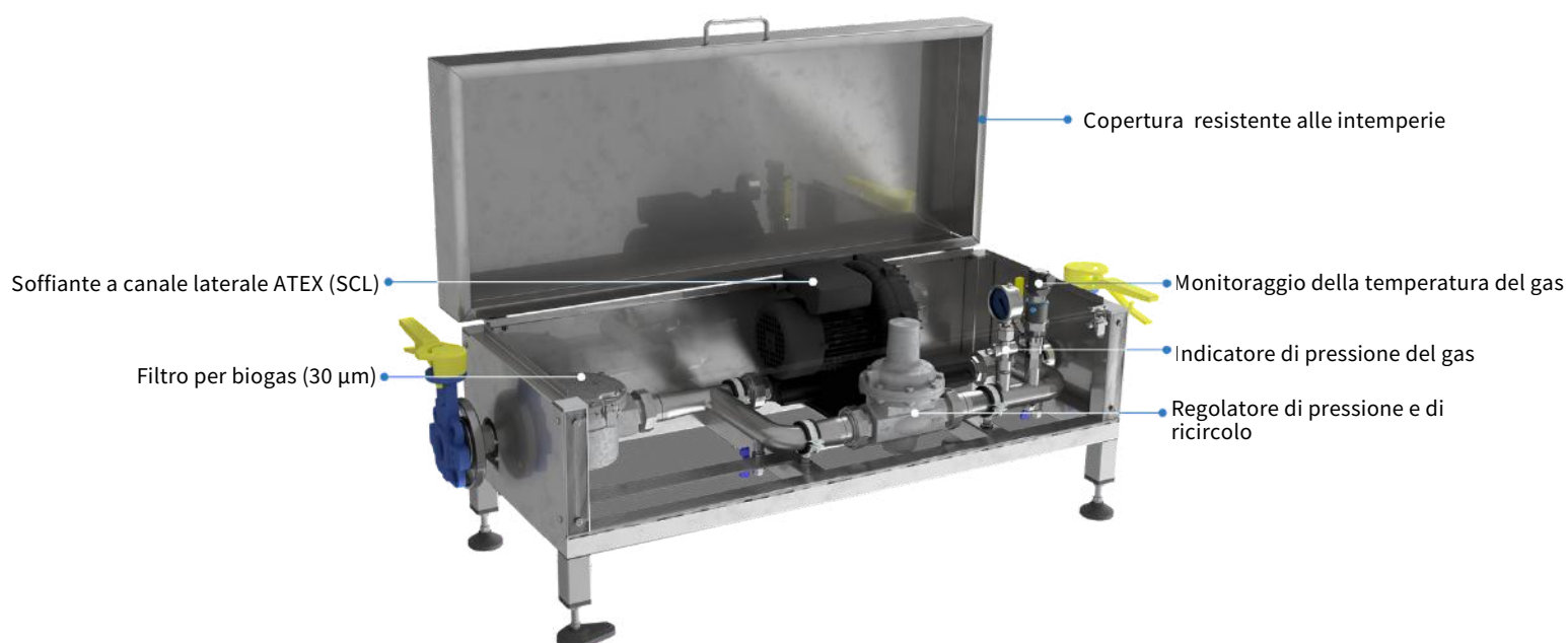
SKV08: COSTRUZIONE IN UN CONTAINER
