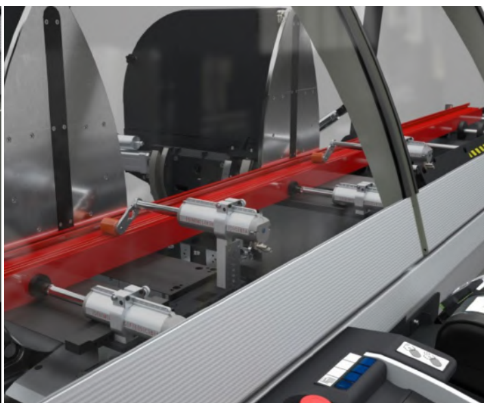
El bloqueo del perfil para el corte se realiza de forma sumamente precisa y segura a través de dos prensas horizontales.
