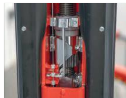
Såfremt liften møder en forhindring, stopper liften automatisk via det indbyggede obstruktionssystem.
