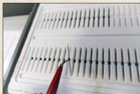
RFID-chip, to antenner og et printkort lægges ind i 2 lag gummi
