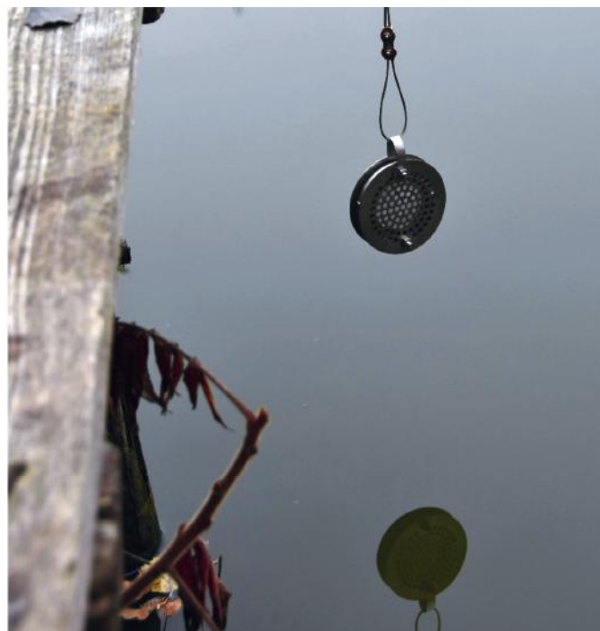
Obr.4: Zavěšený POCIS v ochranné mřížce připravený k instalaci.
