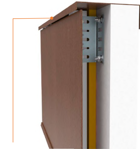
Forro de coronación
