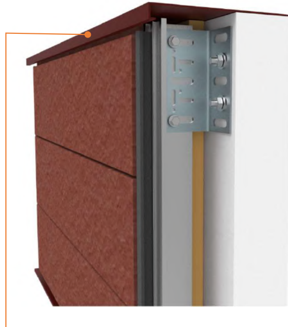
Forro de coronación
