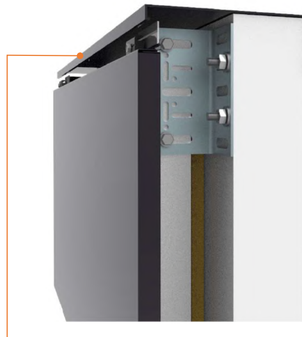
Forro de coronación
