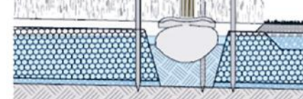
Stockage de l'eau dans une fosse d'arbre
