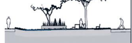
Stockage de l'eau dans un bassin à ciel ouvert
