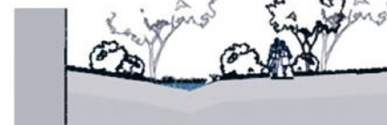
Stockage de l'eau dans la noue de la rue Edith-Burger
