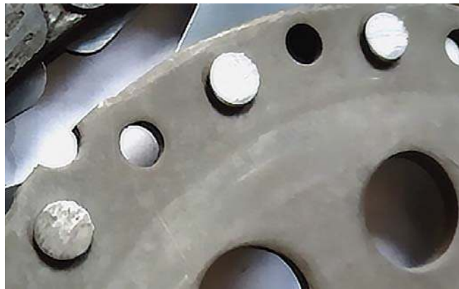
Мал. 1. Стерті заклепки диска зчеплення
