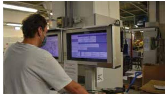
Mit schlanken Shopfloor-Terminals können Fertigungsmitarbeiter das MES HYDRA direkt an der Maschine bedienen (Bildquelle: Salinen Austria).
