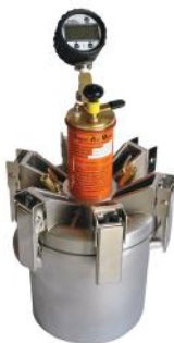
Fig. 4: Equipo para determinar el contenido de aire mediante el método secuencial. (SAM) (foto cortesía de Tyler Ley, Oklahoma State University)
