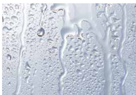
Stekajúca voda na skle bez antiplakovej úpravy.
