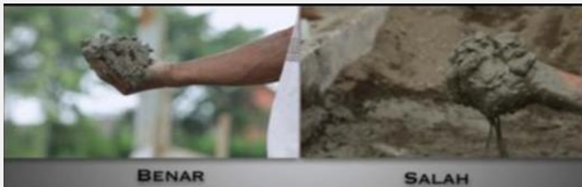
Pengujian Sederhana dengan Meletakkan Campuran Beton di Tangan
