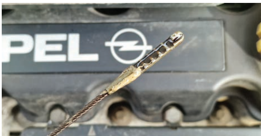
Ilustracja 4. Żółta lub biała barwa i maślana konsystencja oleju może sygnalizować problemy z układem chłodzenia silnika.
