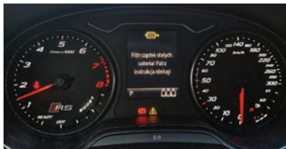
Ilustracja 2. Włączona kontrolka sygnalizuje problem z filtrem GPF w Audi RS3 (powodem było niezaktualizowane oprogramowanie sterujące 4-cylindrowym silnikiem o mocy 400 KM).
