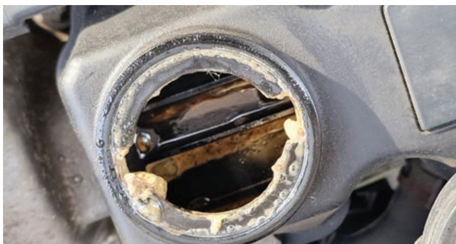
Ilustracja 5. Maślana zawiesina może oznaczać problemy z uszczelką pod głowicą (zdiagnozowanie takiej awarii wymaga dalszych czynności i pomiarów).
