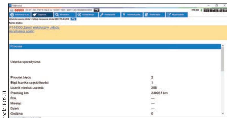
Ilustracja 3. W sterowniku silnika Audi A4 2.0 TDI został zarejestrowany kod usterki P144000, który dotyczy problemów z zaworem EGR.
