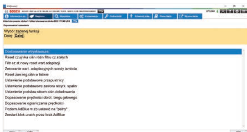
Ilustracja 7. Lista funkcji dopasowania/ustawienia poszczególnych parametrów w układzie oczyszczania spalin pozwala na kompleksową obsługę i naprawę zgodnie z zaleceniami producenta pojazdu.
