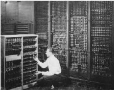
Se construye en la Universidad de Pennsylvania la ENIAC (Electronic Numerical Integrator And Calculator), que fue la primera computadora electrónica de propósito general.
