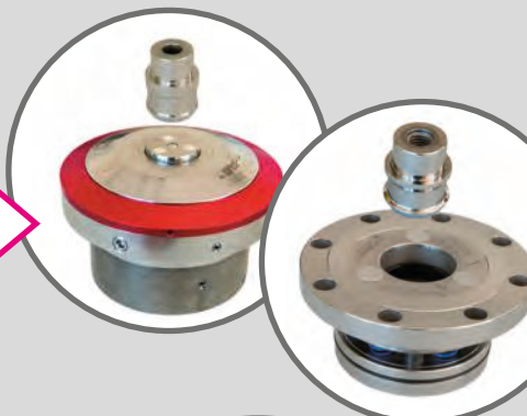
Mocowania z punktem zerowym – szybka i bezpieczna wymiana detali, narzędzi i przyrządów z natychmiastowym pozycjonowaniem
