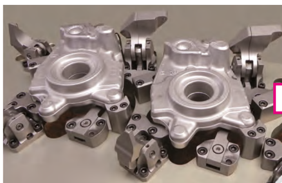
Komponenty hydrauliczne do przyrządów obróbkowych. Wiele typów siłowników mocujących, podporowych, centrujących
