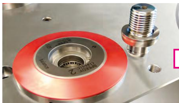
Mocowania z punktem zerowym – szybka i bezpieczna wymiana detali, narzędzi i przyrządów z natychmiastowym pozycjonowaniem
