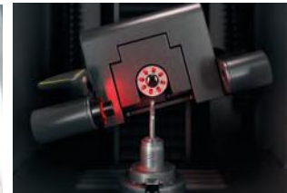
Uchylny statyw kamery w ZOLLER »threadCheck«
