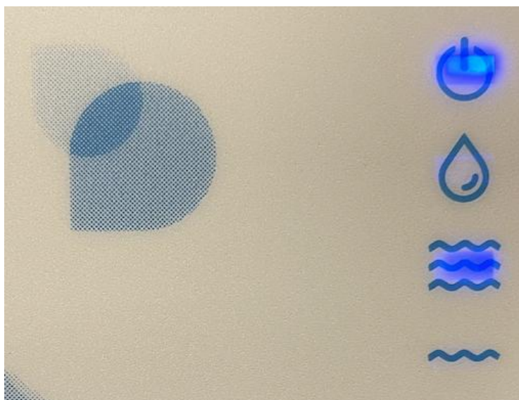
Figura 3 – Estado Ligado Nível Máximo e Circulação Forçada
