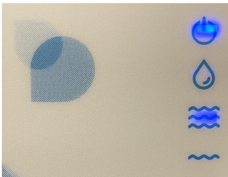
Figure 3 – État activé Niveau maximal et circulation forcée
