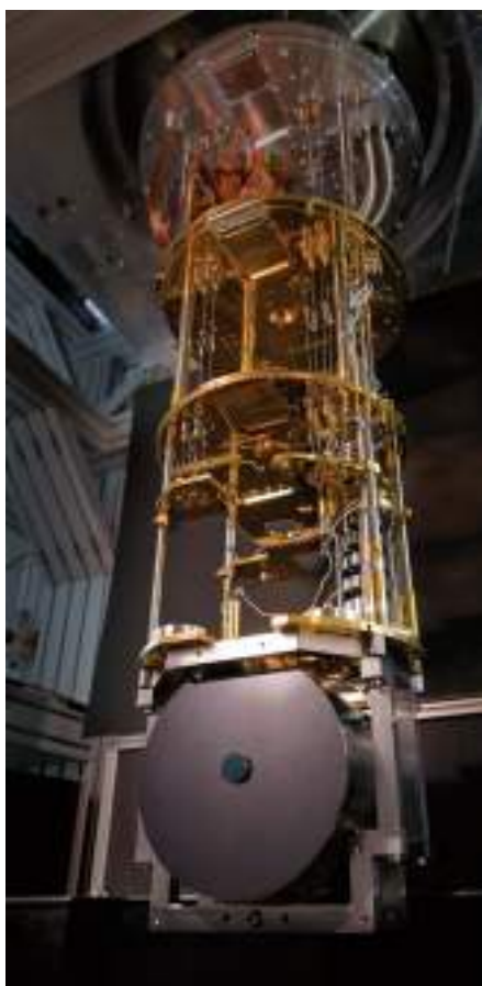
Enceinte (hauteur environ 2m) abritant le dispositif de détection des particules ultralégères. La cavité se trouve à l'étage inférieur. Photo FEMTO-ST
