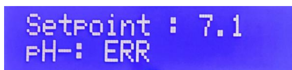
Figure 7 - Menu de démarrage avec erreur de sonde
