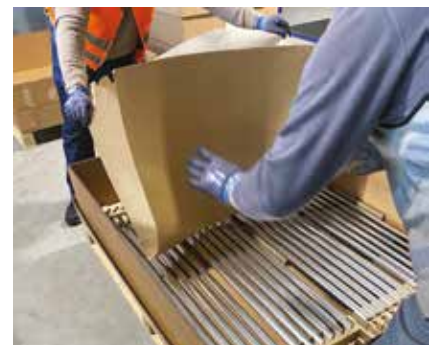
Das Pralinenpapier hat eine glatte und eine offene Seite. Die glatte Oberfläche wird in Richtung Zierleiste gelegt, um jede Möglichkeit von Kratzern zu verhindern.
