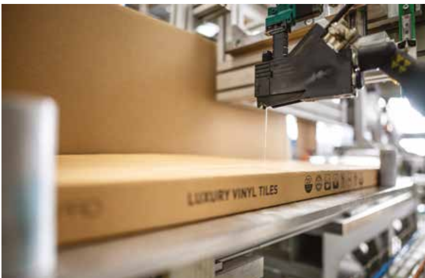
Erster Schritt: Klebstoffauftrag von oben mit Auftragskopf SX auf die Faltkartonschachtel.
