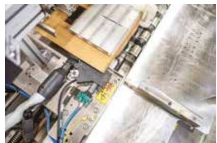
Zweiter Schritt: Seitlicher Raupenauftrag mit Auftragskopf SX auf die Faltkartonschachtel.
