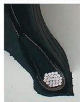
RSC + UHP dæk: (V - W - Y - Z) Joint Bead Wire = Lav montage tolerance. Billede: RSC kantråds-opbygning.
