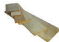
Palettes en kevlar (x4) 70mmx46mmx5.85mm pour pompe huilée
