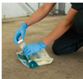
Pliage en chassant l'excédent d'air
