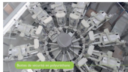
Manège à injection PU / Bekina
