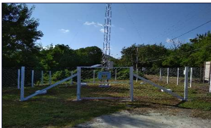
Figura 8 - Estação meteorológica da marca Campbell instalada em Fernando de Noronha-PE.
