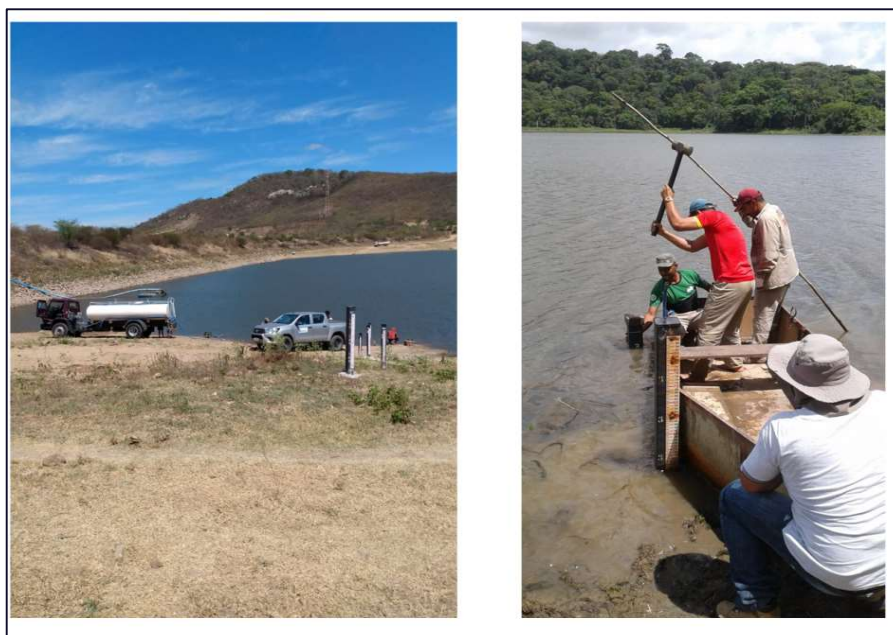
Figura 15 - Manutenção da estação de régua linimétrica em reservatório.
