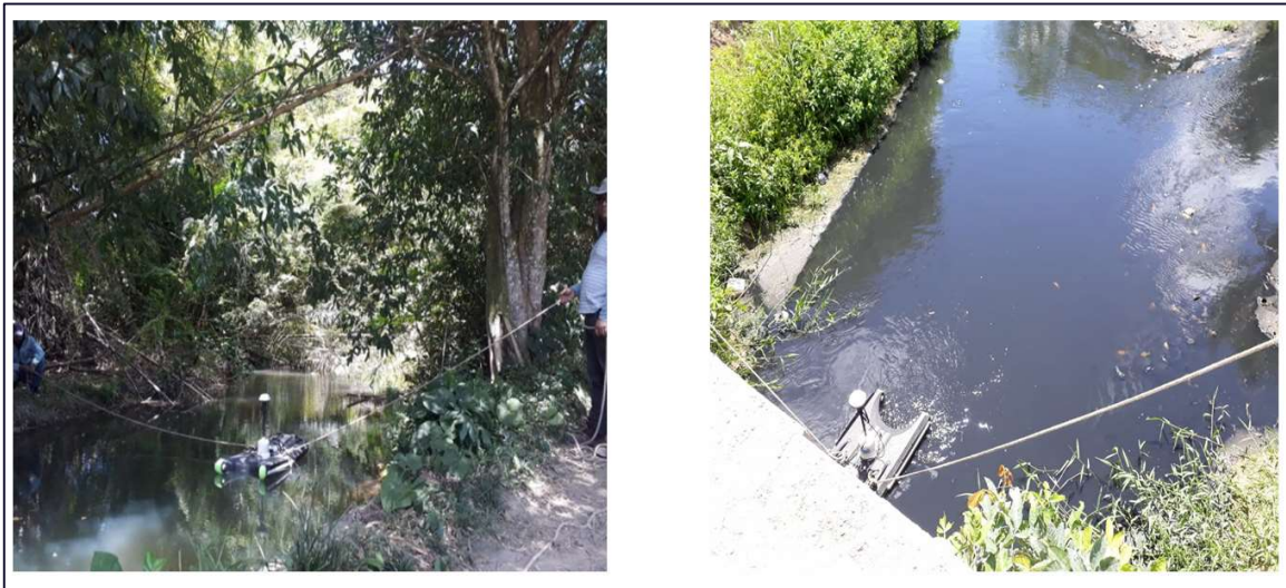
Figura 14 – Medição de vazão com medidor acústico tipo ADCP (Acoustic Doppler Current Profiler) modelo M9 para o programa Qualiágua na estação PA-10 localizada no Rio Paratibe a esquerda e na estação TB-30 localizada no Rio Timbó a direita.
