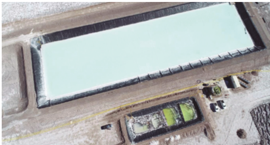
Pileas experimentales para purificación de litio en la cuenca de Laguna Verde, Catamarca. ROBERTO LENCINA.
