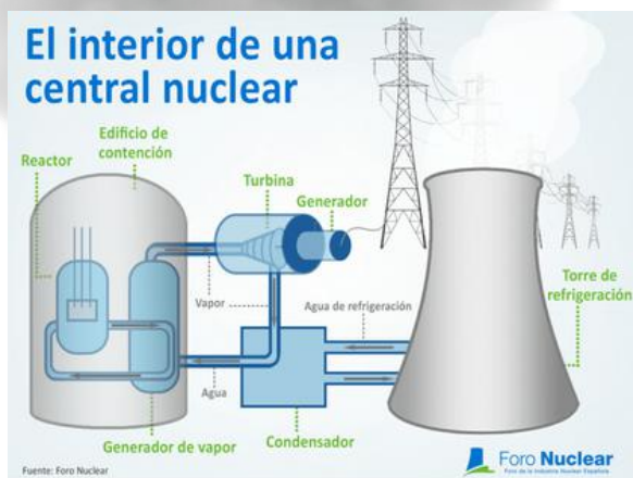
Figura 1. Esquema del funcionamiento de un reactor nuclear; el reactor calienta agua, que genera vapor para mover una turbina y así generar electricidad.
