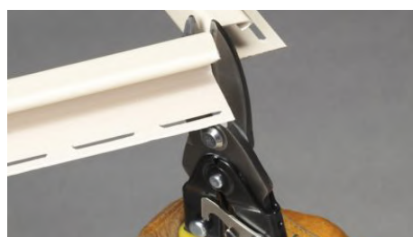
Mise en situation cisaille sur plastique
