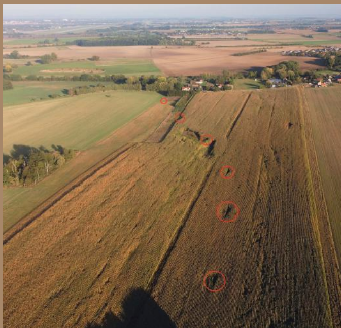
Odvodnění údolnice od prameniště melioračním zařízením (foto Envicons, letecký snímek Mapy.cz)
