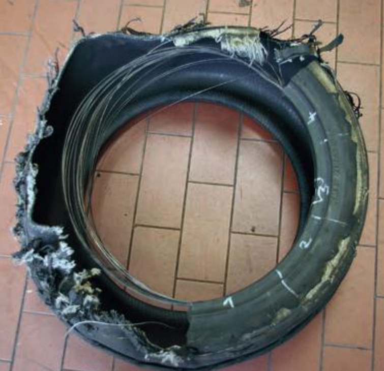
Det eksploderede dæk fra eksempel 1, hvor en BMW-ejer forulykkede, som følge af fejlagtig montering af dækket fra værkstedets side.
