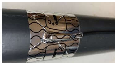
Figure 6 – Installation de sonde de température
