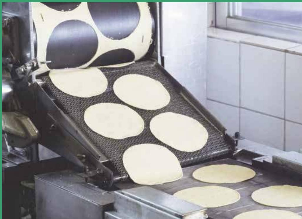
Los rodillos y moldes cortadores se usan en lugar del palmeado o la prensa; y las bandas transportadoras –que son tres, para lograr cocer la tortilla de un lado, del otro, y nuevamente del primer lado– toman el lugar del comal y del proceso de estar vigilando y volteando la tortilla.
