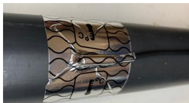
Figura 4 – Instalação da Sonda de Temperatura
