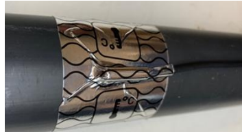
Figura 4 - Instalación de la sonda de temperatura
