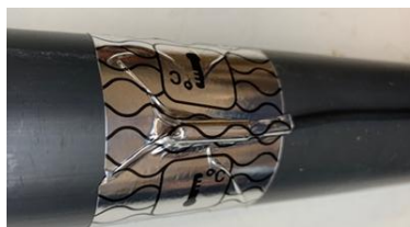
Figura 4 – Installazione della sonda di temperatura
