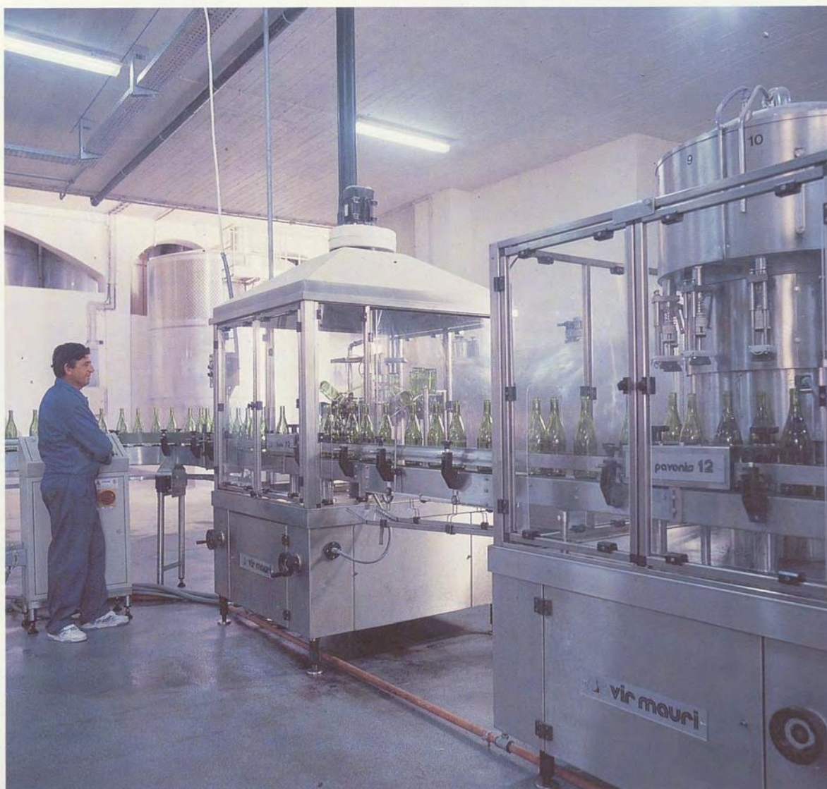
Εικ. 81 Τό συγκρότημα αυτόματης εμφιάλωσης τών κρασιών στο οίνοποιείο τής «Ένωσης» συνεταιρισμών.
