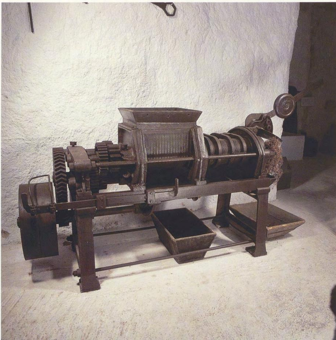
Εικ. 37 Όριζόντιο συνεχές μεταλλικό σταφυλοπεστήριο, από τα πρώτα που ήρθαν στο νησί (Μουσείο Οίνου της Σαντορίνης).
