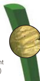
Fibre de gazon vieillie par les UV avec surface écaillée
