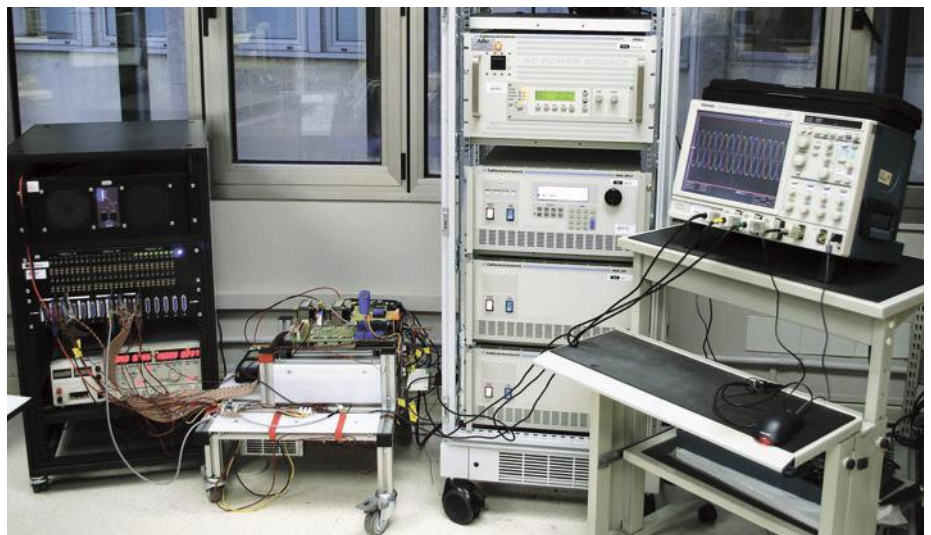
EHUko APERT ikerketa-taldeko laborategian garatutako potentzia-bihurtgailu matrizial hutsegite-tolerantzia learen plataforma esperimental. Ezkerretik eskuinera: kontrolaz arduratzen den RT-Lab eMEGAsim gailu digitala, MCaren prototipoa, iturri eta karga programagarriak eta osziloskopioa. ARG.: © EORDIA IBARRA/EHU.
