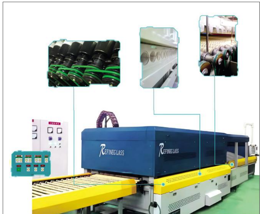
Horno de templado por radiación KENOBI+ YR-A .
